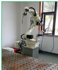
图1 FD-B6全位置焊接机器人臂
