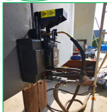
图3 CV模拟件焊接
