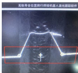
图1 坡口激光识别、跟踪界面
