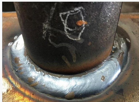
焊缝外观形貌
